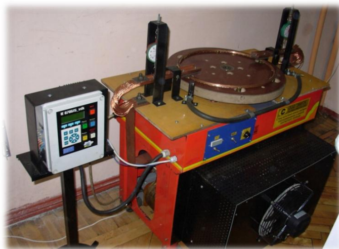
Рис. 1. Загальний вигляд стенду з дослідження зносу контактного проводу.
