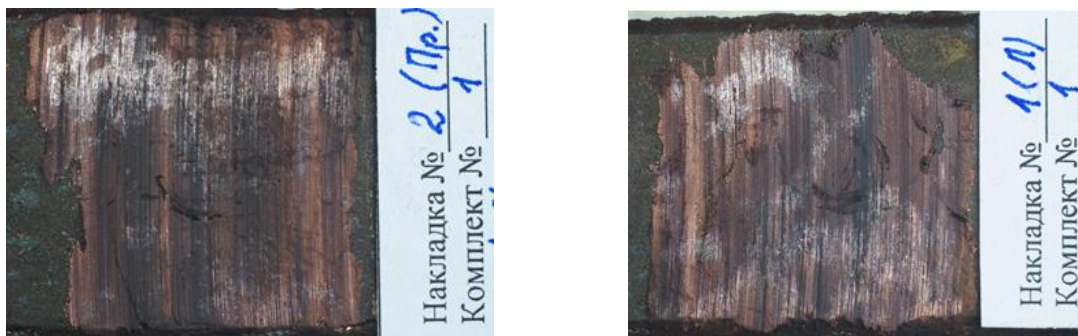
Рисунок 5 – Стан поверхні контактних вставок після 50 тис. проходів
