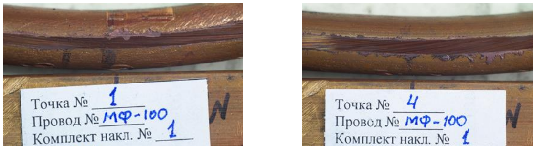
Рисунок 4 – Стан поверхні контактної проводу після 50 тис. проходів
